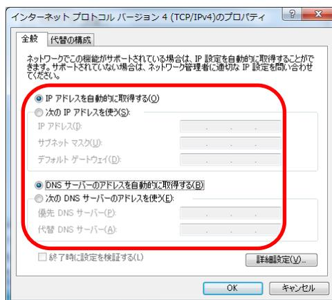
※既に IP アドレスと DNS サーバーに値が指定されていた場合は以下にメモをした上で”自動的に取得する”に変更して下さい。
