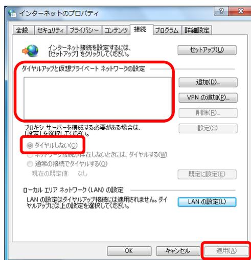
5.2.3 [LAN の設定]ボタンをクリックし[自動構成]、[プロキシサーバー]欄のチェックを全て外し[OK]ボタンをクリックします。
